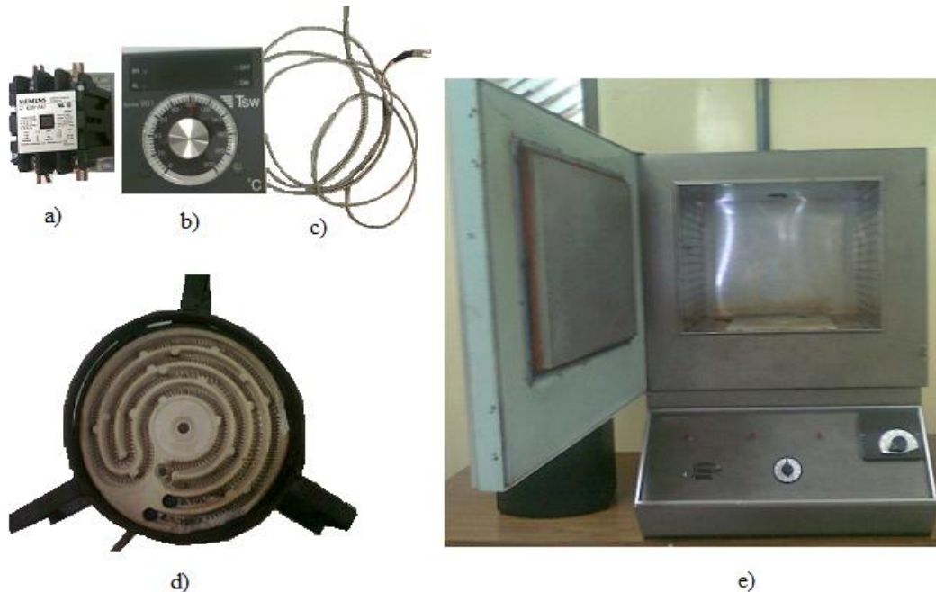
Figura 4.22 Equipo a) relevador b) controlador de temperatura c) termopar tipo J d) resistencia calefactora e) horno.
